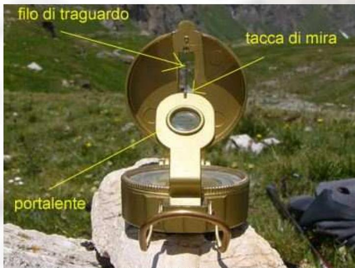
L'ago della bussola si dispone verso il nord e possiamo leggere, attraverso la lente del portalente, il valore dell'azimut direttamente sulla scala. A differenza della bussola da carteggio, lo 0 della scala coincide sempre con la direzione al nord (la scala è solidale con l'ago e ruota con esso), per cui leggiamo subito il valore dell'azimut in corrispondenza dell'asse della bussola (ovvero dell'indice di lettura una volta allineato con l'asse della bussola, vedi foto successiva).
